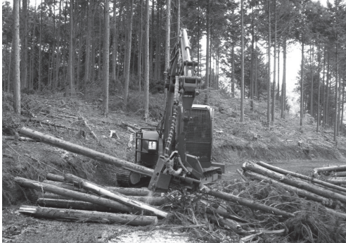
伐採した木材の搬出作業
