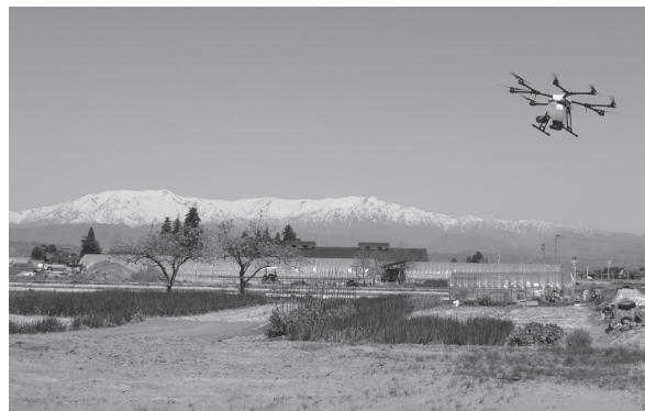
葉色・雑草状況を診断し肥料・農薬散布する栽培支援ドローン
