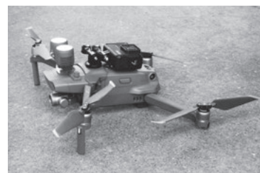
橋梁点検用小型ドローン
